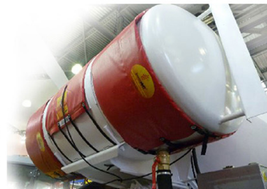
Нагреватель для бака воды автобетоновоза
